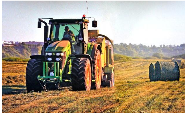
Рисунок 1. Трактор JOHNDEERE с пресс-подборщиком формирует тюки с сеном
