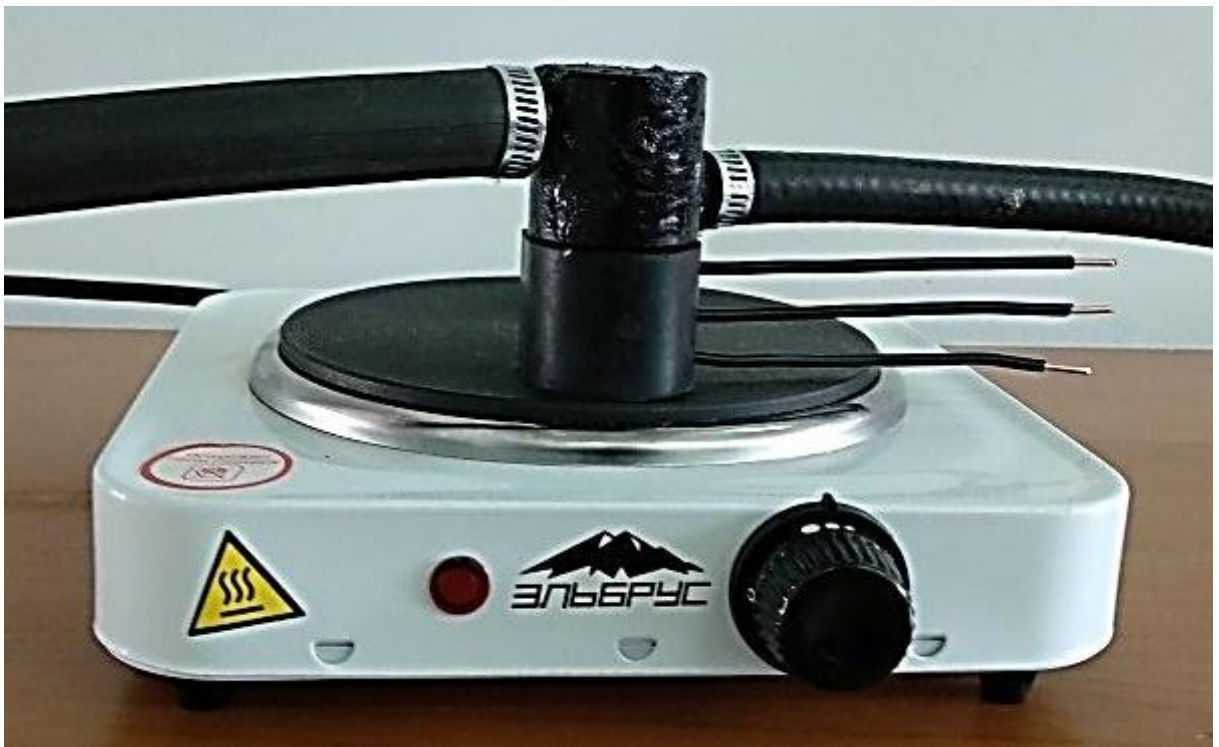
1 – холодильник; 2 – втулка резиновая в сборе с медными дисками и образцом; 3 – электрическая шита с терморегулятором
