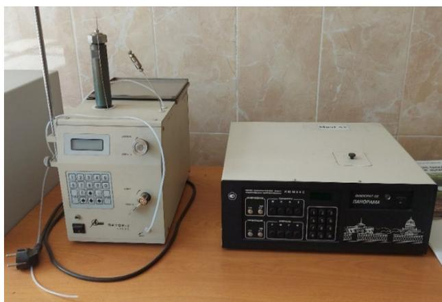
Рисунок 2.2 – Прибор для определения  $\beta$ -каротина «Флюорат-02»
