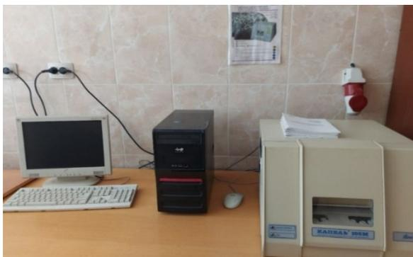
Рисунок 2.3 – Прибор для определения макроэлементов («Капель 105М»)
