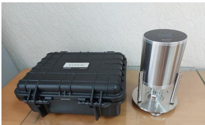
Рисунок 2.6 - Вискозиметр АТАГО
