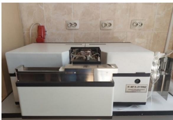
Рисунок 2.4 - Атомно-абсорбционный спектрометр с электротермической атомизацией и коррекцией неселективного поглощения «МГА-915МД»
