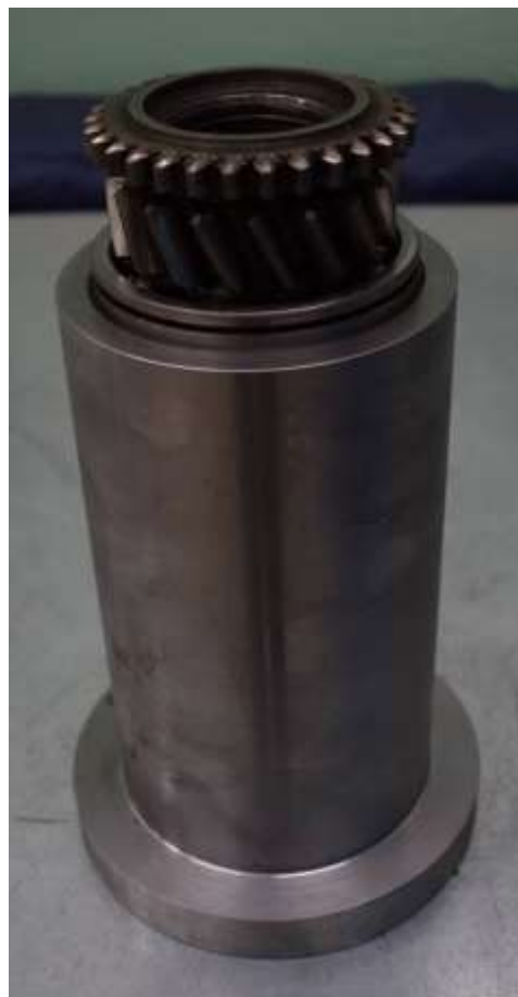
Рисунок 4.46 – Сборка и центрирование деталей клеевого соединения «первичный вал-подшипник» коробки передач КАМАЗ-4310
