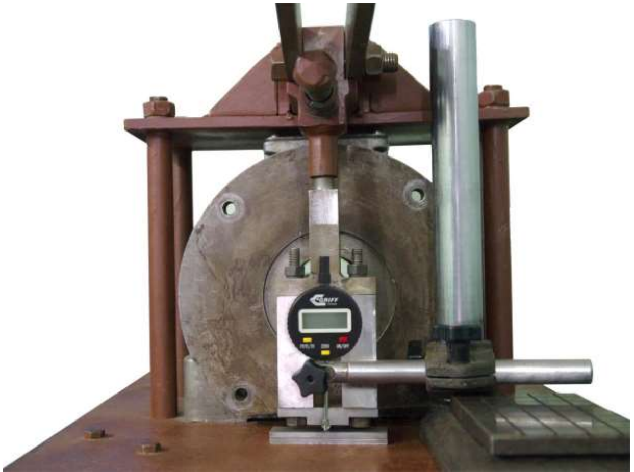
Рисунок Г.2 – Исследование коэффициента постели К
