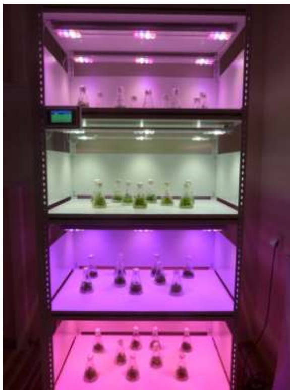
Рисунок 17 - Фитостеллаж со светодиодными модулями освещения X-bright FitoLED с возможностью регулирования спектрального состава и интенсивности излучения
