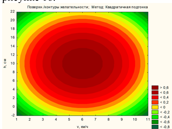
Рисунок 15 - Двумерное сечение поверхности отклика
