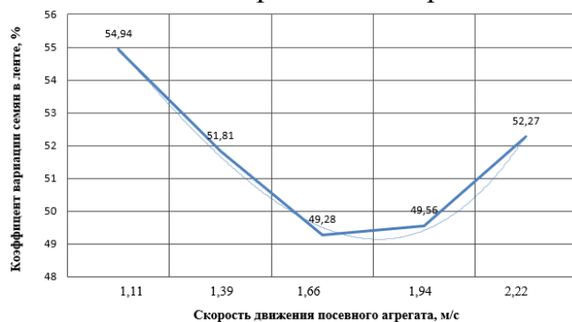
Рисунок 12 – Зависимость равномерности распределения семян от скорости движения посевного агрегата
