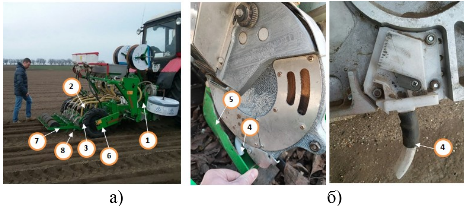
Рисунок 11 - Общий вид посевного агрегата МТЗ-82.1+посевная машина, оснащенная модернизированным пневматическим высевающим аппаратом с подающим устройством криволинейного типа: а) общий вид; б) сошник с криволинейным семенопроводом; 1 – рама; 2 – бункер; 3 - высевающий аппарат пневматического типа; 4 – семенопровод; 5 – сошник; 6 – опорно-приводное колесо; 7 - уплотняющий каток; 8 – загортачи
