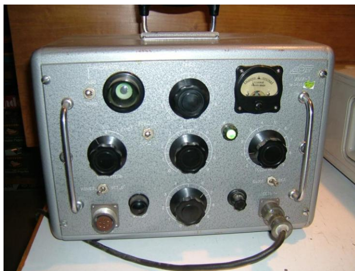
Рисунок 20. Измеритель магнитной индукции ИМИ-3
