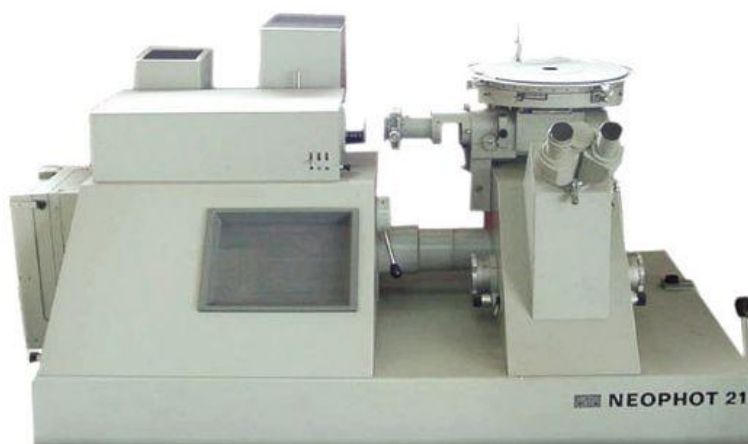
Рисунок 21. Металлографический микроскоп Carl-Zeiss Iena Neophot 21
