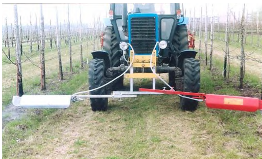
Обработка приствольных полос в интенсивном саду гербицидами при помощи гербицидной штанги
