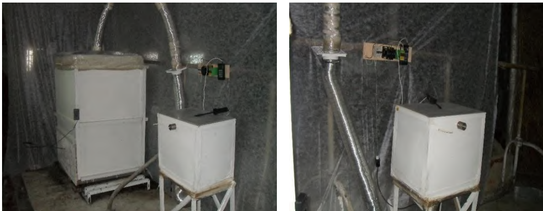
Лабораторная установка по моделированию процесса биологической фильтрации газов
