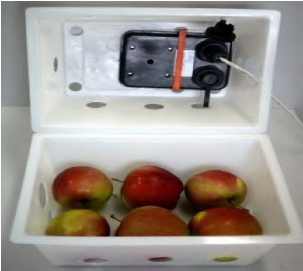
Перфорированный пластиковый контейнер с датчиком флуоресценции
