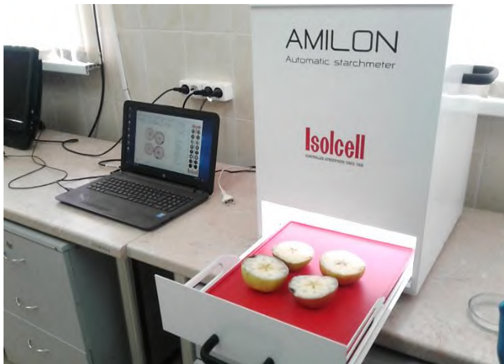
Прибор для определения степени зрелости плодов яблони Amilon
