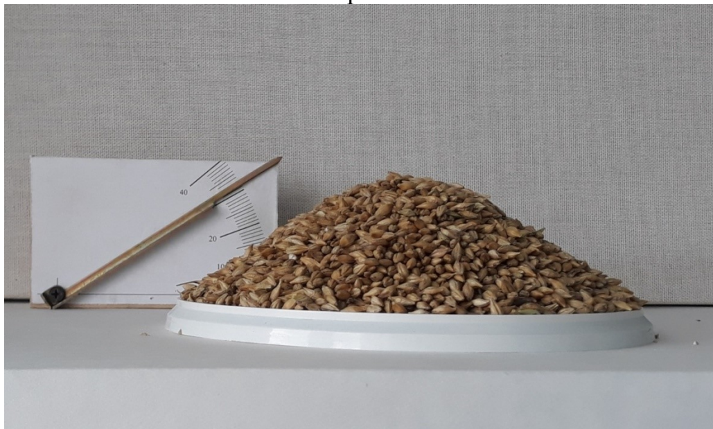
Рисунок 3.2 – Процесс измерения угла естественного откоса
