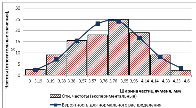
Рисунок 2.16 – Экспериментальное и теоретическое распределение ширины частиц ячменя
