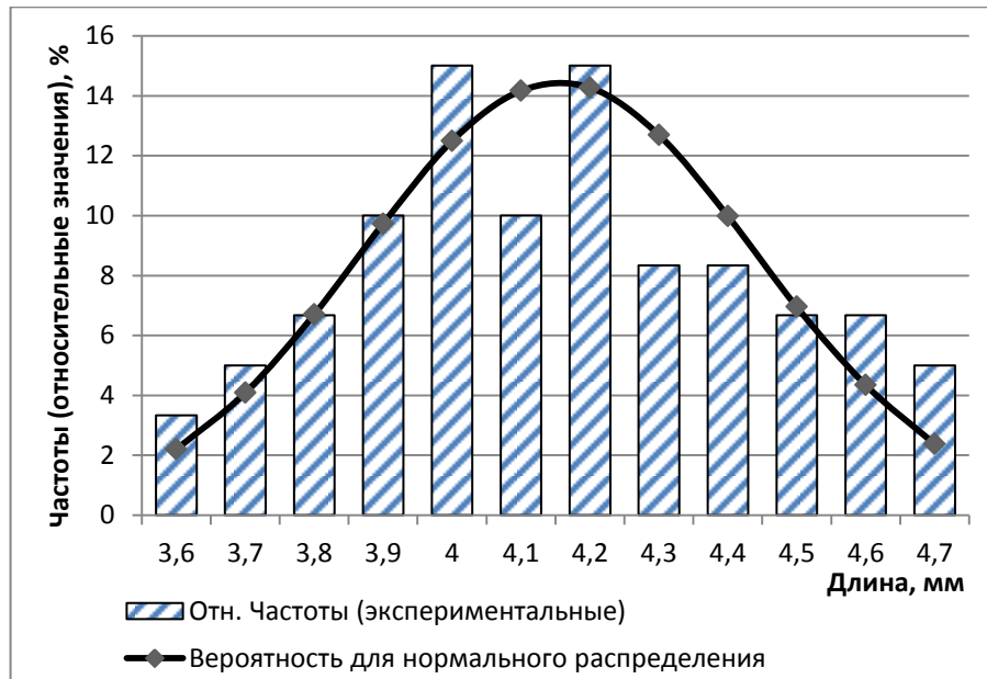
Рисунок 2.2 – Экспериментальное и теоретическое распределение длины частиц сорго
