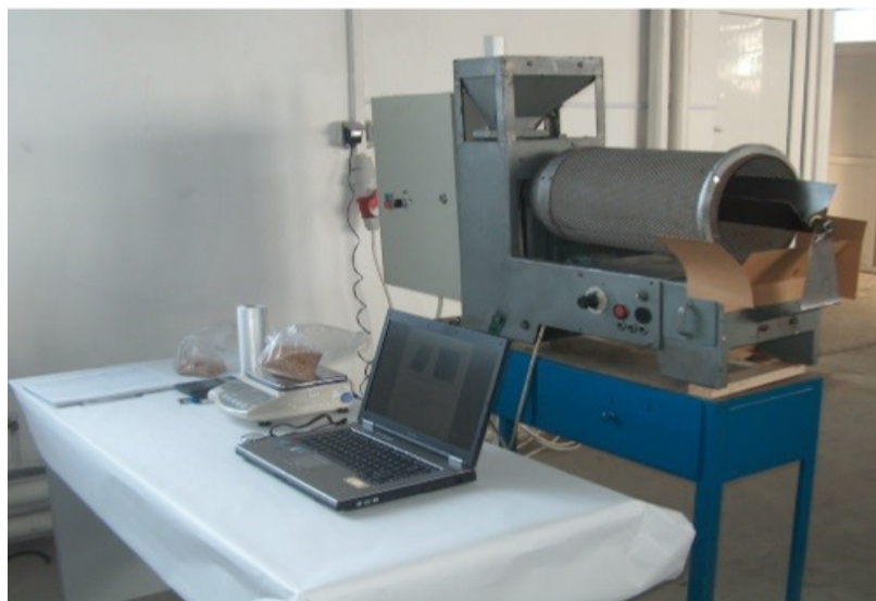
Рисунок 1.22 – Стенд для исследования рабочего процесса триерных сепараторов
