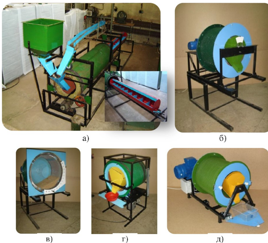
Рисунок 1.17 – Стенды для исследований процессов триерной очистки конструкции ФГБНУ ВНИИТиН
