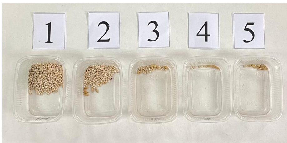
Рисунок 4.16 – Динамика выделения семян сорго из ячменя при: m_n = 1250 г; Z_n = 2\% ; n = 55 об/мин; \gamma_n = 45^\circ
