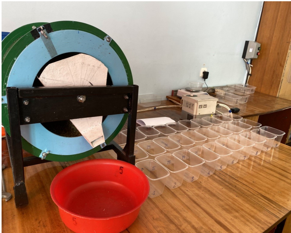
Рисунок 3.5 – Прибор для исследований процессов триерной очистки
