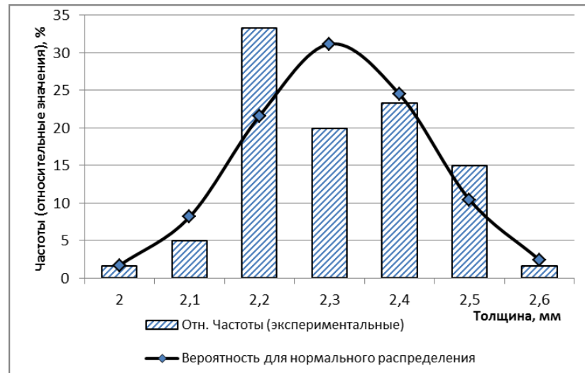
Рисунок 2.6 – Экспериментальное и теоретическое распределение толщины частиц сорго
