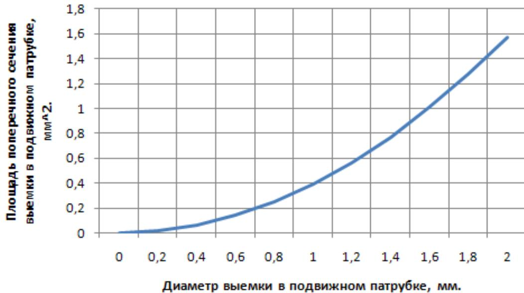
**Рисунок 2.8 – Площадь поперечного сечения выемки в подвижном патрубке**
