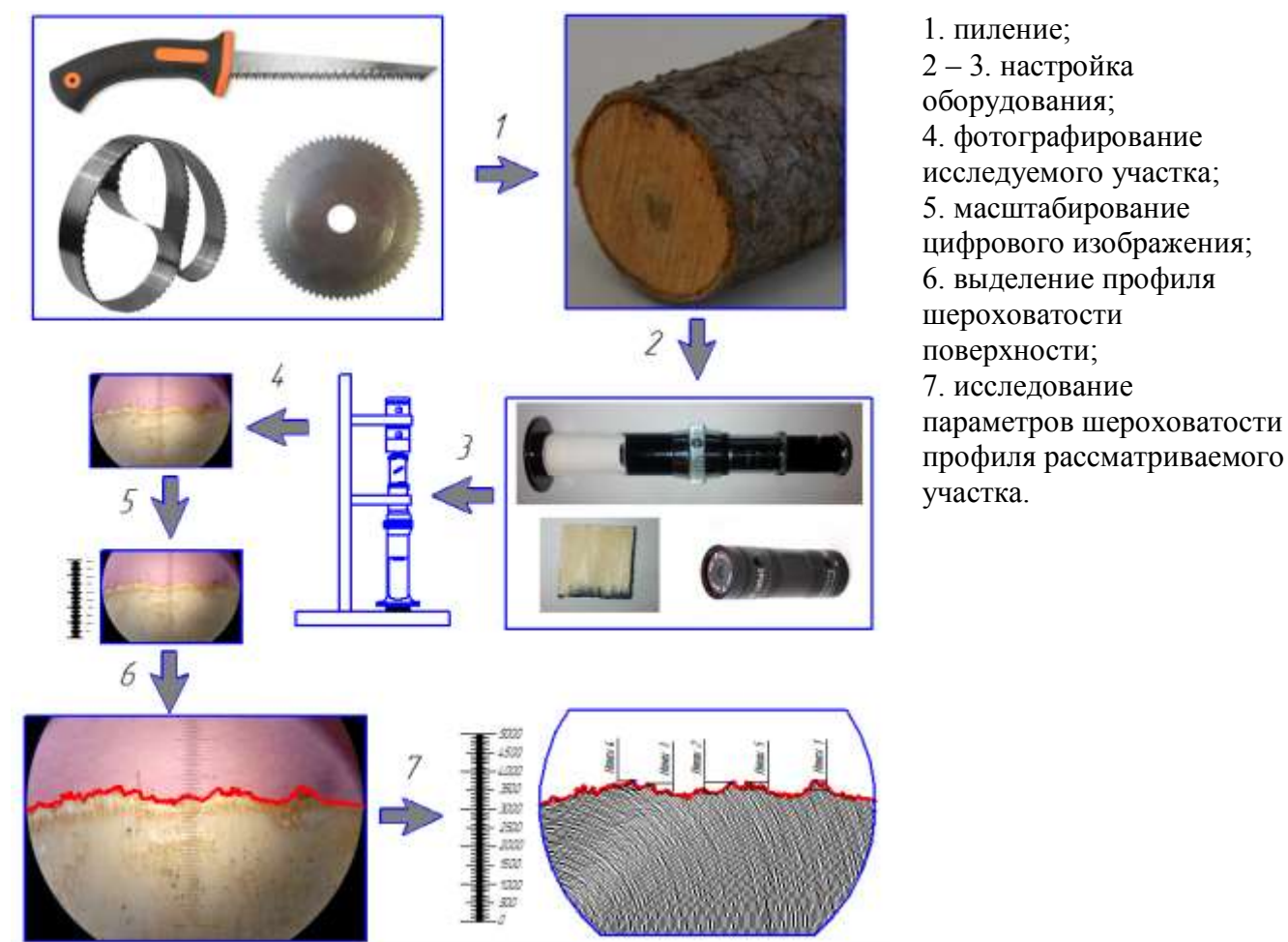
Рисунок 3.7– Последовательность измерения шероховатости поверхности
