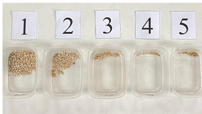
Рисунок 13 – Навески выделенных семян сорго при: m_n = 1000 г; Z_n = 2\% ; n = 55 об/мин; \gamma_n = 45^\circ
