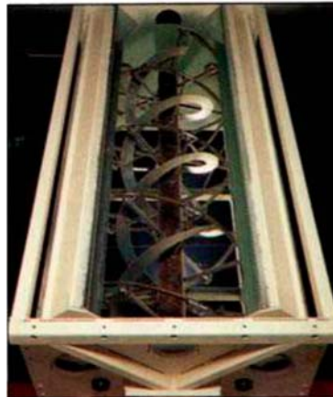
Рисунок 1.12 - Ленточный одновальный смеситель фирмы «Wuyveen International B.V.» [20]
