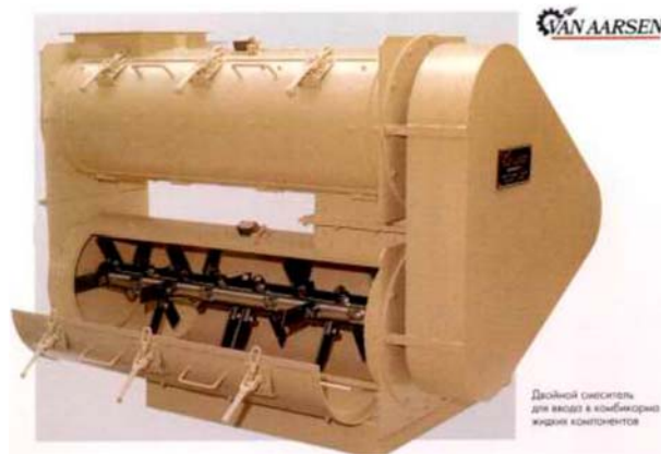
Рисунок 1.11 - Лопаточной смеситель для сыпучих продуктов фирмы «Van Aarsen» [154]
