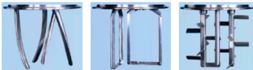
Рисунок 1.9 - Варианты исполнения рабочих органов планетарного смесителя
