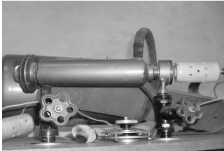
Рисунок 5.13 – Фото вихревой трубки, обеспеченной рубашкой охлаждения внешнего корпуса
