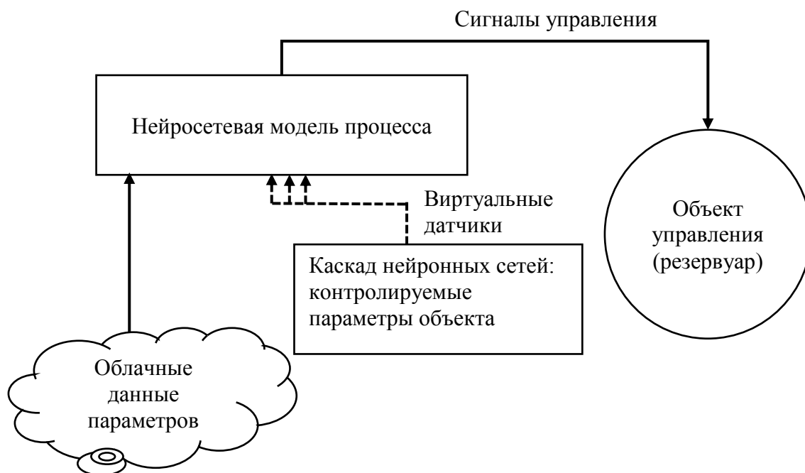
Рисунок 3.9 – Виртуально-облачная схема автоматизации объекта управления (резервуара) с применением нейронных сетей
