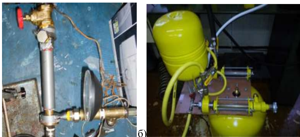
Рисунок 4.5 – Фото лабораторной установки ступенчатого блока вихревых труб (а) и вихревого модуля (б)
