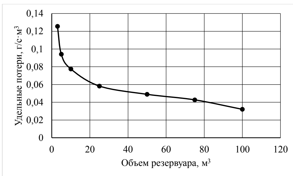
Рисунок 2.6 – Удельные потери топлива при заполнении резервуара
